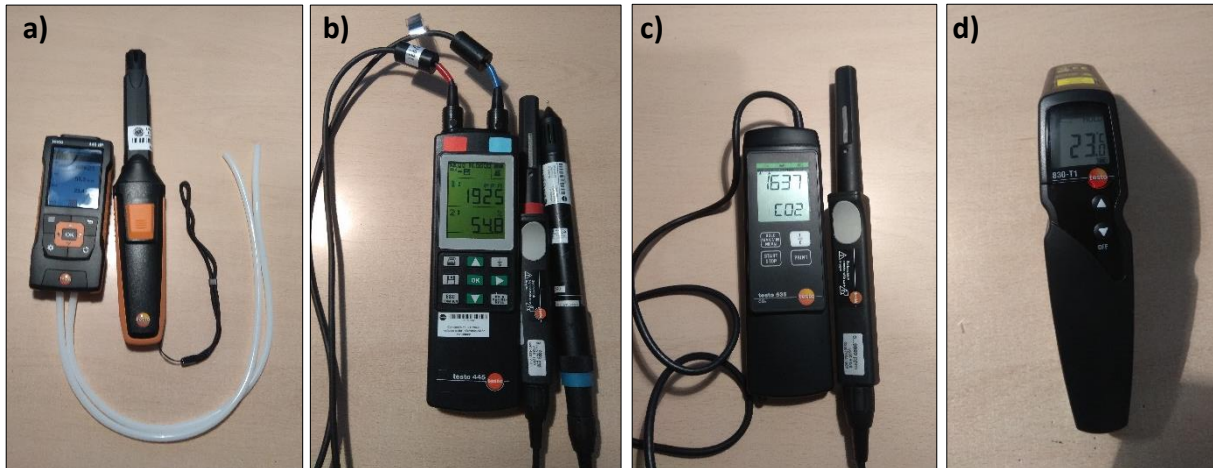
Figura 27. Equipos de medida usados en el ensayo Testo 440dP (a), Testo 445 (b), Testo 535 (c) y Testo 830-T1 (d).
