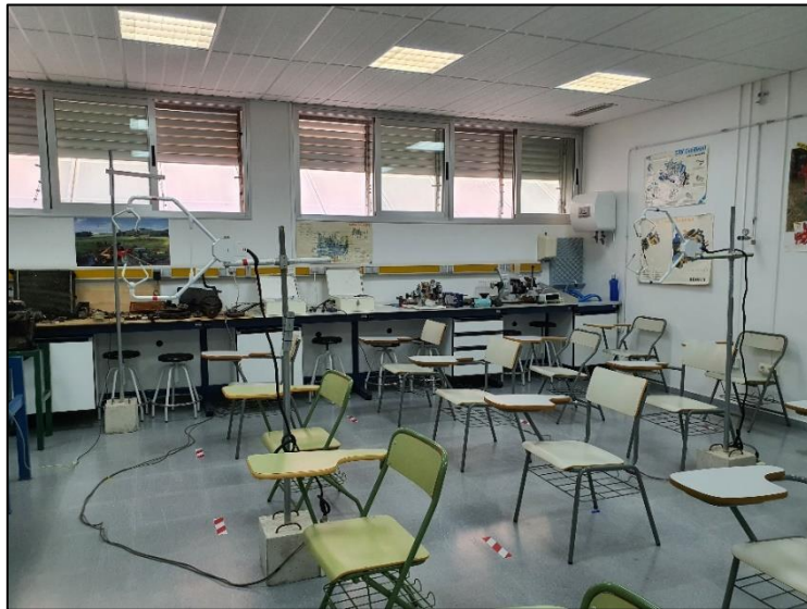
Figura 33. Imagen de los anemómetros sónicos 3D empleados en el ensayo.
