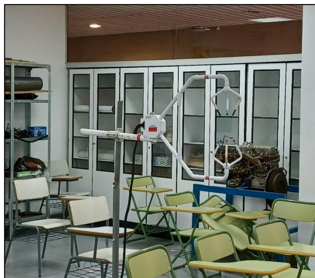
Figura 28. Anemómetro sónico 3D para la medida de la velocidad del aire en el interior del laboratorio.
