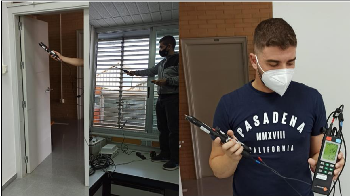
Figura 19. Instrumentos de medida Testo 440dP y Testo 445 situándose para las mediciones en los cuadrantes de las ventanas y puerta.
