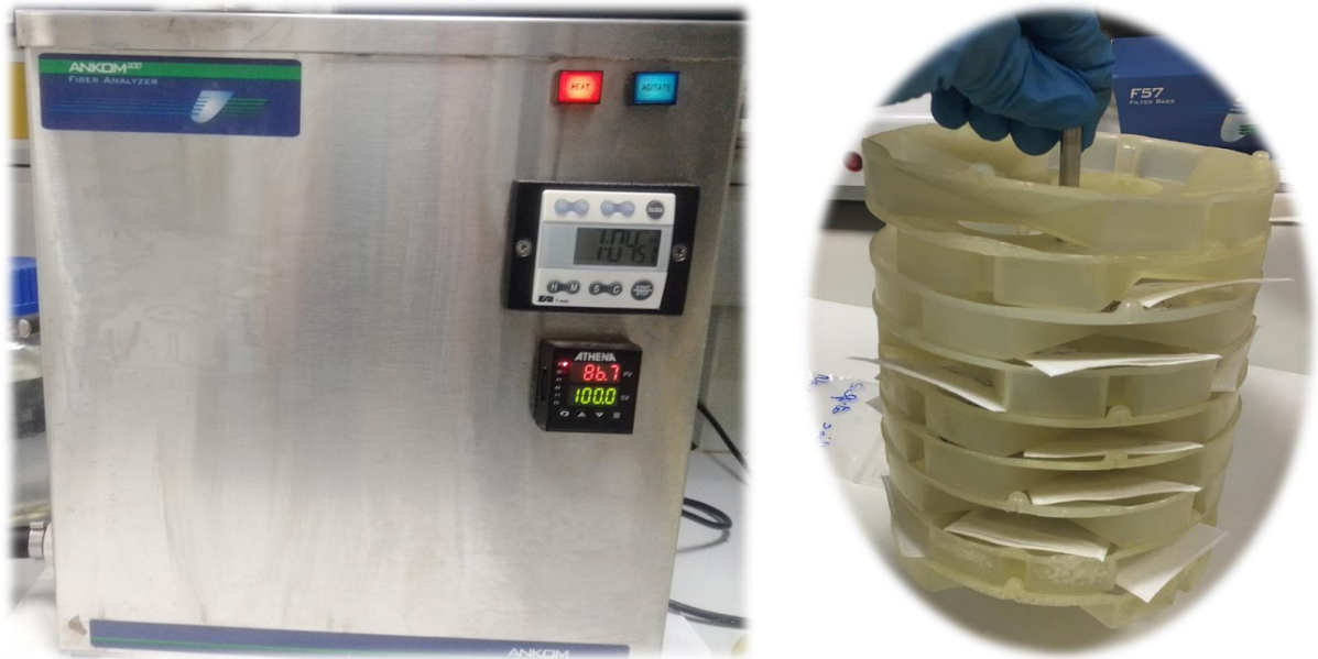
Figura 14. Digestor ANKOM 200/220 (izda.) y detalle del soporte de muestras (dcha.).
