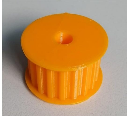
b) Diseño final de la polea pequeña
