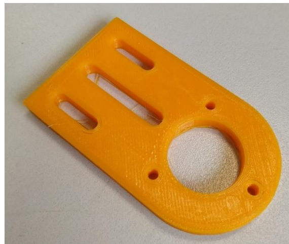
Figura 3.16. Soporte del encoder.
