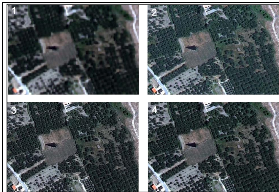
Figura 6. Imagen original (1); fusión con ACP (2); fusión con High Pass Filter (3) y fusión con el método de Gram-Smith (4) en parcelas de frutales de regadío.
