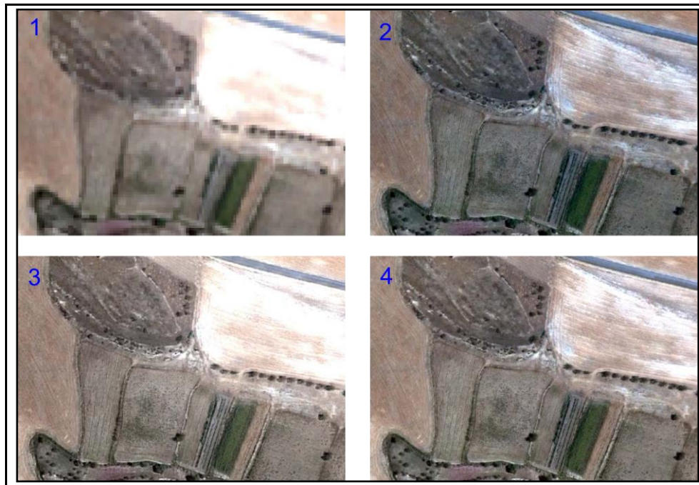
Figura 3. Imagen original (1); fusión con ACP (2); fusión con High Pass Filter (3) y fusión con el método de Gram-Smith (4) en parcelas de cereal.
