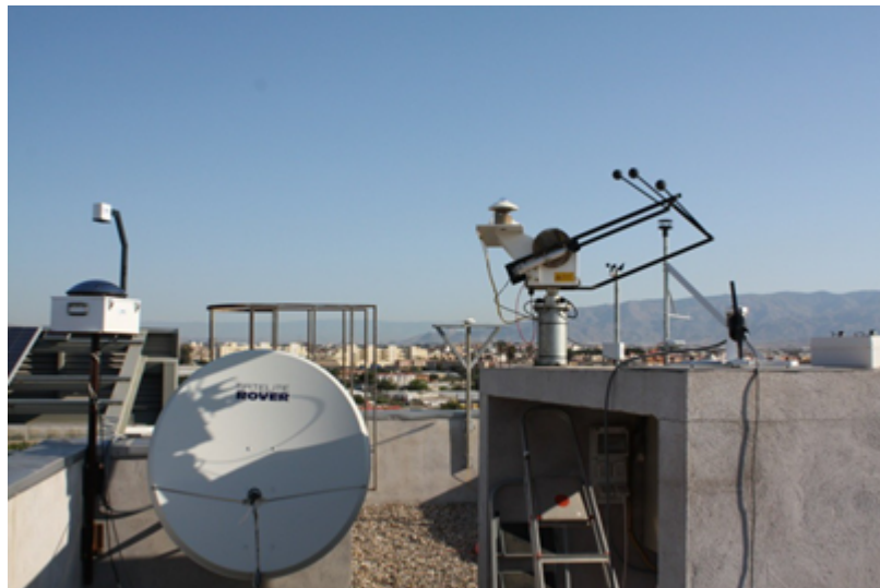
Figura 21. Estación meteorológica: cámara de cielo y antena parabólica encargada de establecer comunicación con el satélite geoestacionario Meteosat de Segunda Generación.
