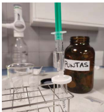
Figura 19. Detalle de la filtración de las muestras de agua con filtro de PTFE.
