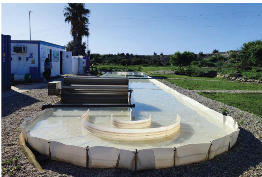
Figura 17. Reactor tipo Raceway de 100 m.
