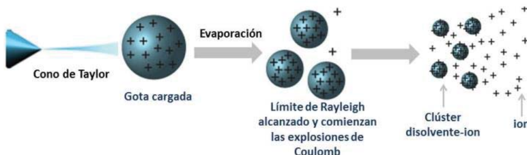
Figura 15. Esquema del proceso de formación del electro spray 75 .
