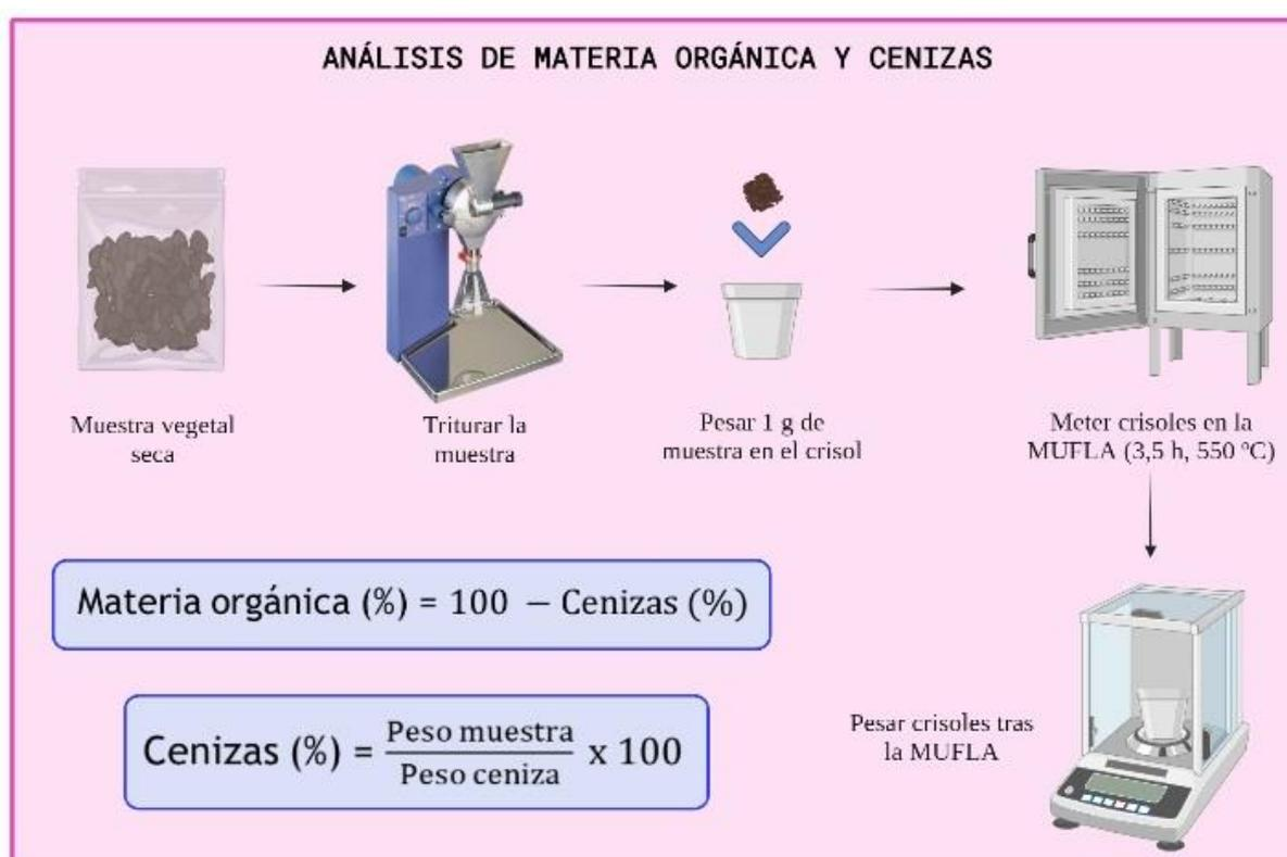
**Figura 13.** Procedimiento para el cálculo del porcentaje de materia orgánica y cenizas de la muestra (Elaboración propia utilizando Biorender).
