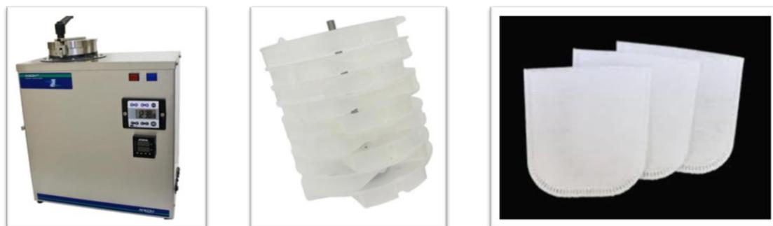
**Figura 17.** Analizador de fibras ANKOM<sup>200</sup>, junto con el suspensor de muestras y las bolsas.
