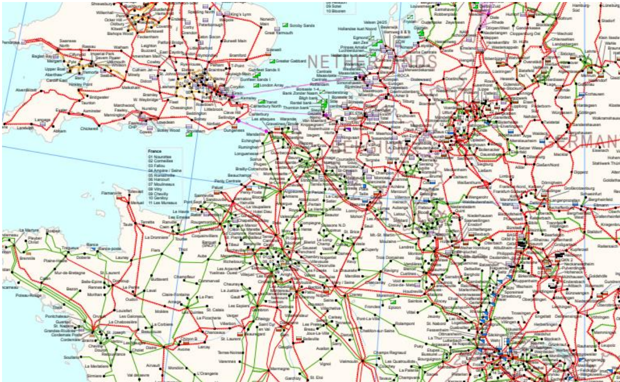
Ilustración 12 Líneas eléctricas de alta tensión en la zona centro-oeste de Europa; Fuente Entsoe (ENTSOE, 2021)
