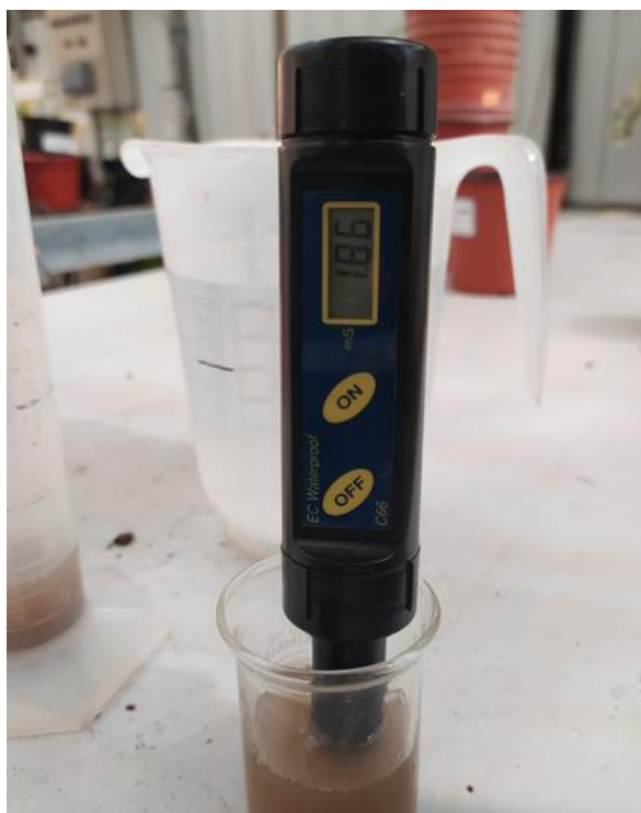
Ilustración 17. Conductivímetro. Marca EC Waterpool, mod. C66.
