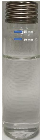
**Figura 23.** Vial HS con las medidas de penetración de la jeringa.
