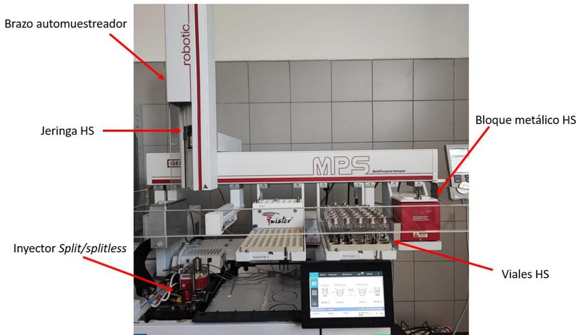
**Figura 9.** Partes sistema MPS Gerstel.
