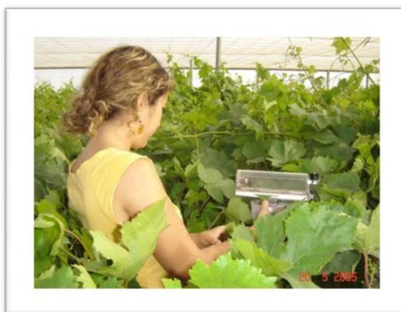
Imagen 18. Medidas de conductancia estomática en hoja en el interior del invernadero.
