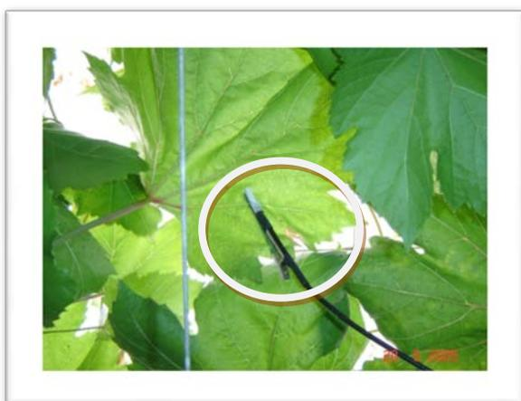
Imagen 17. Sensor termopar fijado a una hoja en el interior del invernadero.
