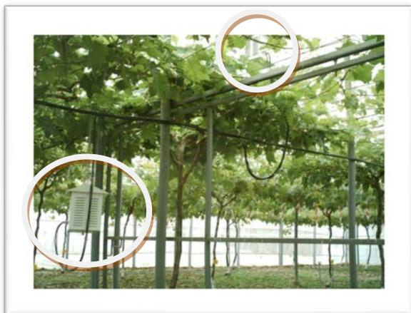
Imagen 15. Aspiró-psicrómetros colocados por encima y por debajo del dosel vegetal en el invernadero.
