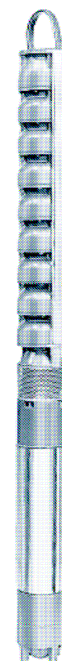
Bombas concebidas para aplicación en pozos a partir de 6" de diámetro y con contenido de arena no superior a 40 g/m 3 . Impulsores semiaxiales en todos los modelos. Temperatura máxima del fluido a bombear 25°C.
