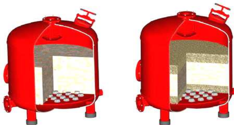
Filtración a través de un lecho multicapa
