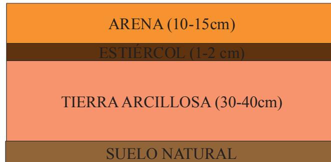
Fig.R7.- Estructura de un suelo enarenado.
