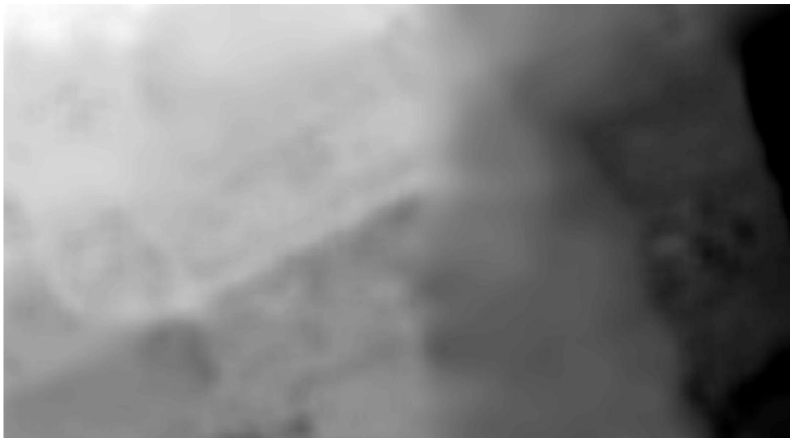
Figura 22: DEM a partir del DSM generado del estéreo par PAN de WV2 (1 m grid). Mediante el algoritmo DSMsDEM
