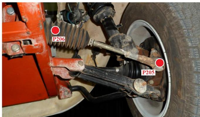
Figura 4.7. Barra de dirección derecha real.
