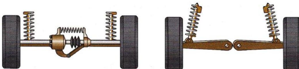
Figuras 2.28 y 2.29. Eje oscilante de una y de dos articulaciones.
