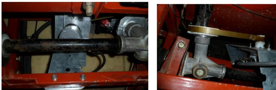
Figura 3.19. Encoder y motor situado en la columna de dirección.
