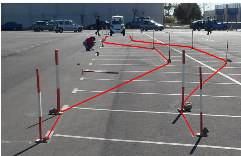
Figura 3.15. Circuito para ensayo de adelantamiento a otro vehículo estacionado
