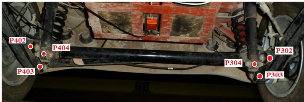
Figura 4.17. Eje rígido trasero real.
