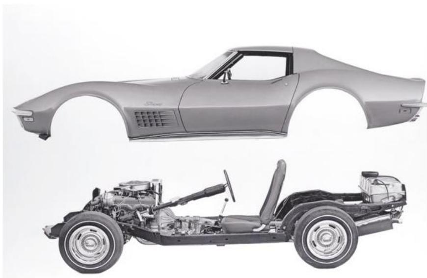
Figura2.1. Chasis y carrocería separados.
