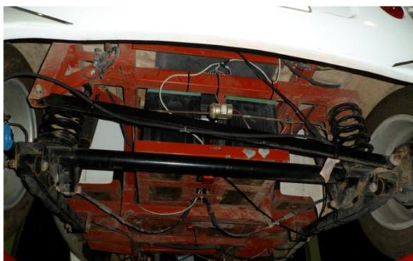
Figura 2.37. Eje rígido con barra Panhard.
