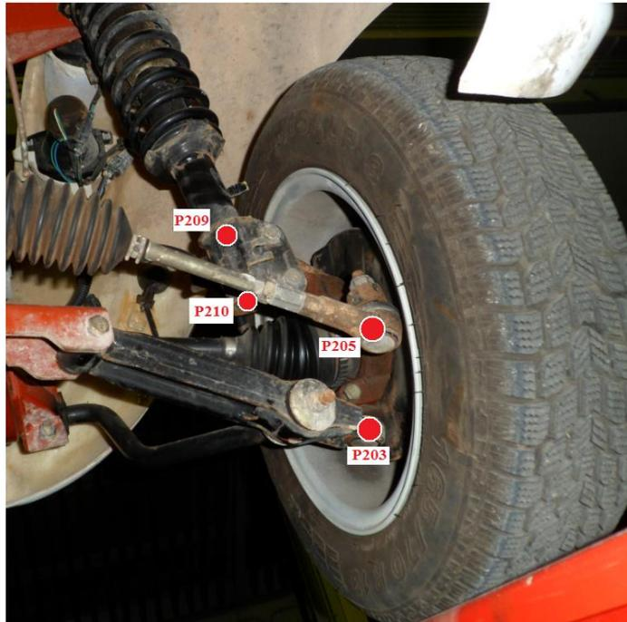
Figura 4.11. Mangueta y suspensión derecha real.
