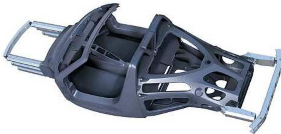
Figura 2.4. Chasis de carbono de Porsche Carrera GT, con un peso de 100 kg.
