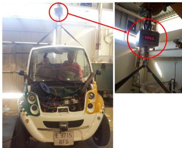
Figura 4.26. Comprobación del centro de gravedad con dos ocupantes
