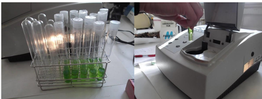
Figura 3.11. Extracción de clorofila y medida de absorbancia.
