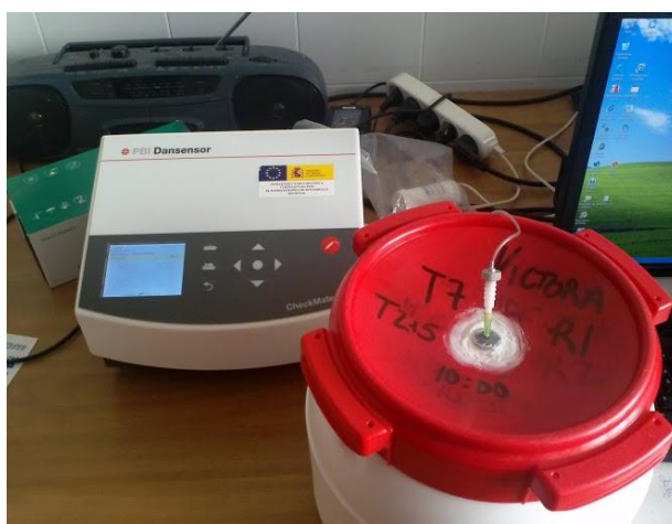
Figura 3.2. Medición de CO 2 y O 2 .
