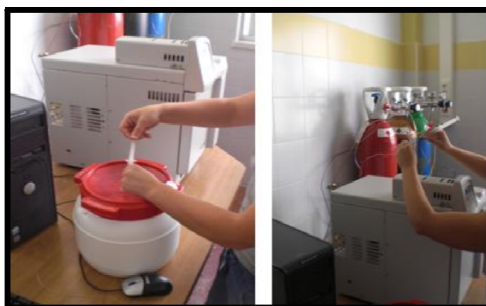
Figura 22. Muestra cómo se extraía el etileno del bote y se introducía en el cromatógrafo de gases.
