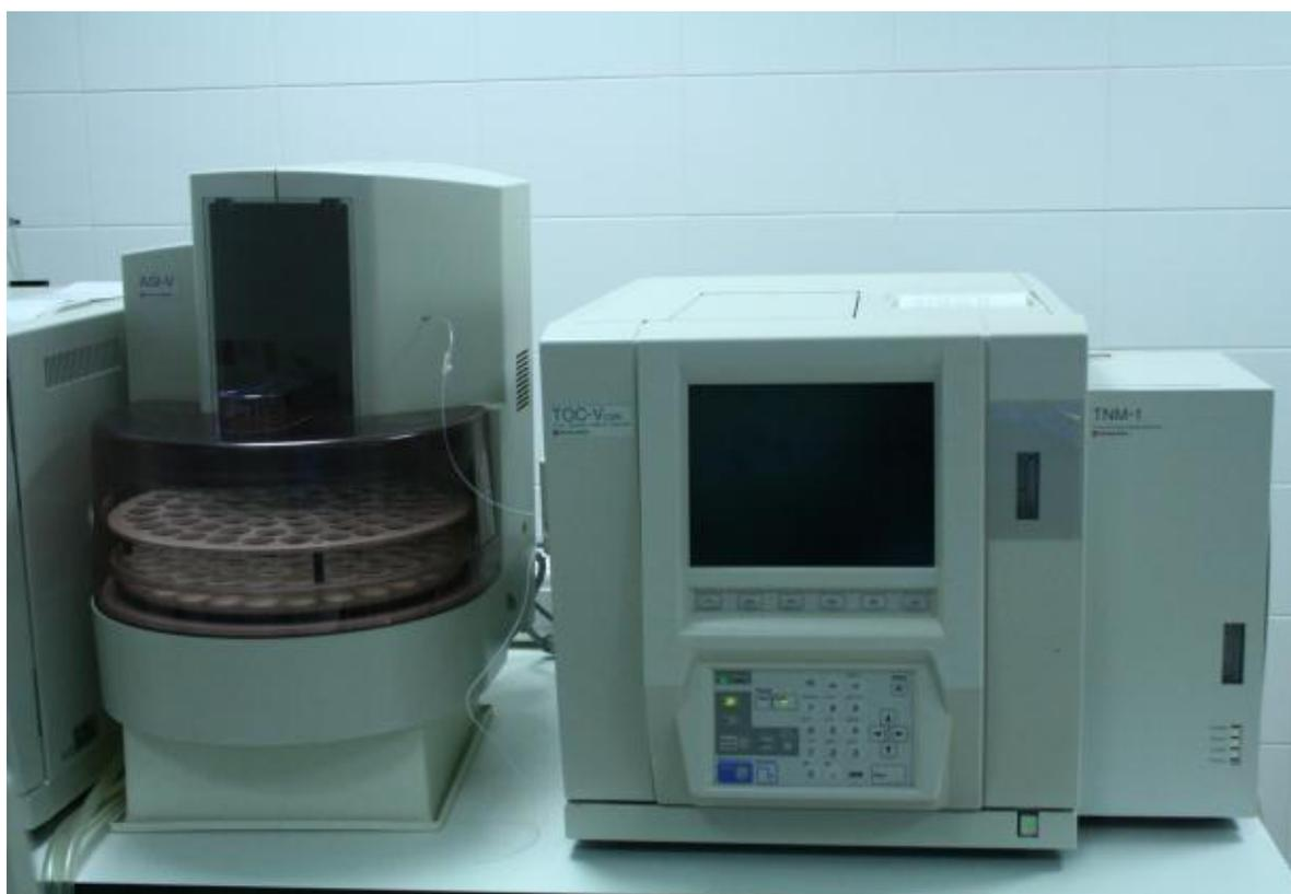
**Figura\_2:** Analizador Shimadzu TOC VCSN con detector de infrarrojo no disperso (NDIR), situado en el laboratorio de química de la Plataforma Solar de Almería.
