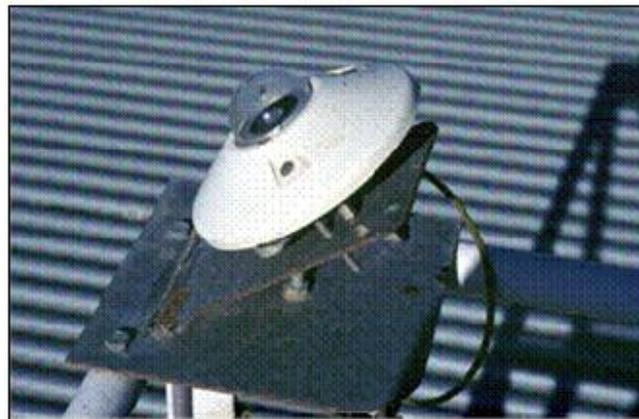
**Figura\_7:** Radiómetro de UV global utilizado en los experimentos realizados en la Plataforma Solar de Almería.
