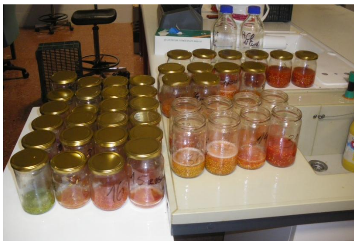
Figura 3.22. Botes llenos de semilla y pulpa junto con una disolución de encima (Pectinex).
