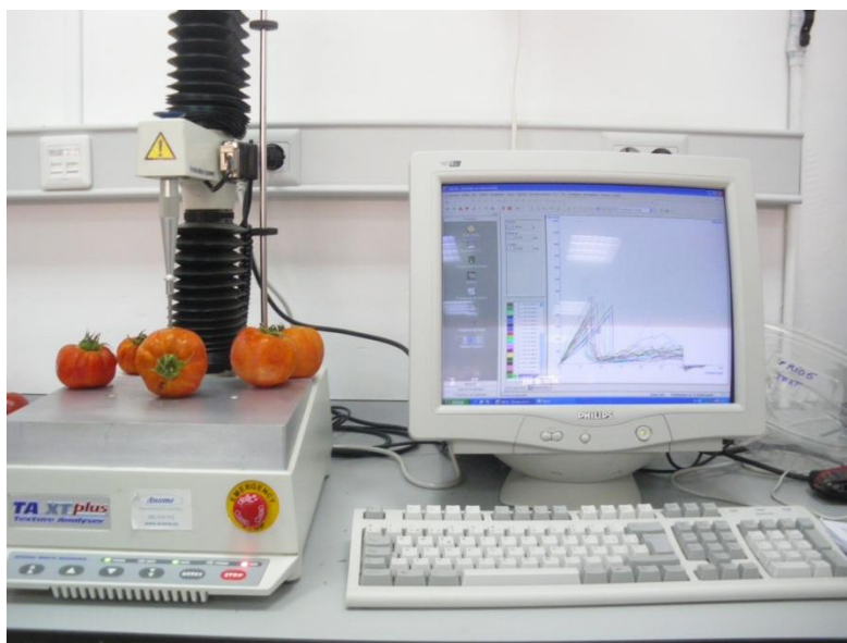
Figura 3.13. Penetrómetro utilizado para medir la firmeza de los frutos de tomate.
