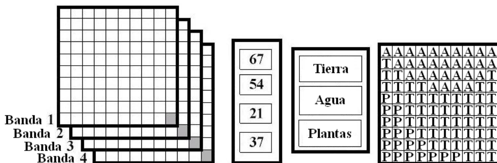
Figura 1.14: Esquema general del proceso de clasificación de imágenes de satélite.
