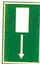
Vía/salida de socorro
