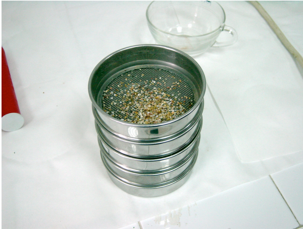
Figura 15. Batería de tamices (Bacchetta et al. , 2008).
