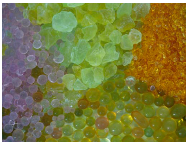
Figura 18. Ejemplos de diferentes tipos de gel de sílice autoindicadores presentes en el mercado (Bacchetta et al. , 2008).
