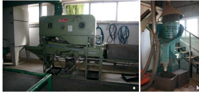
Figura 16. a - Máquina de flujo de aire con cilindro dentado para la separación de semillas (Bacchetta et al. , 2008).
