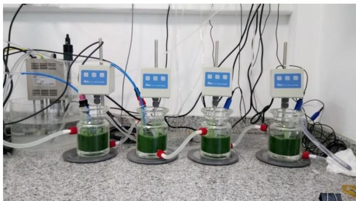
Figura 7: Montaje de reactores para hidrólisis enzimática, con control de pH y temperatura
