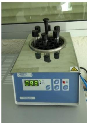
**Figura 5:** Muestras sometidas a rotura celular por calentamiento y NaOH 1N para el análisis de proteínas
