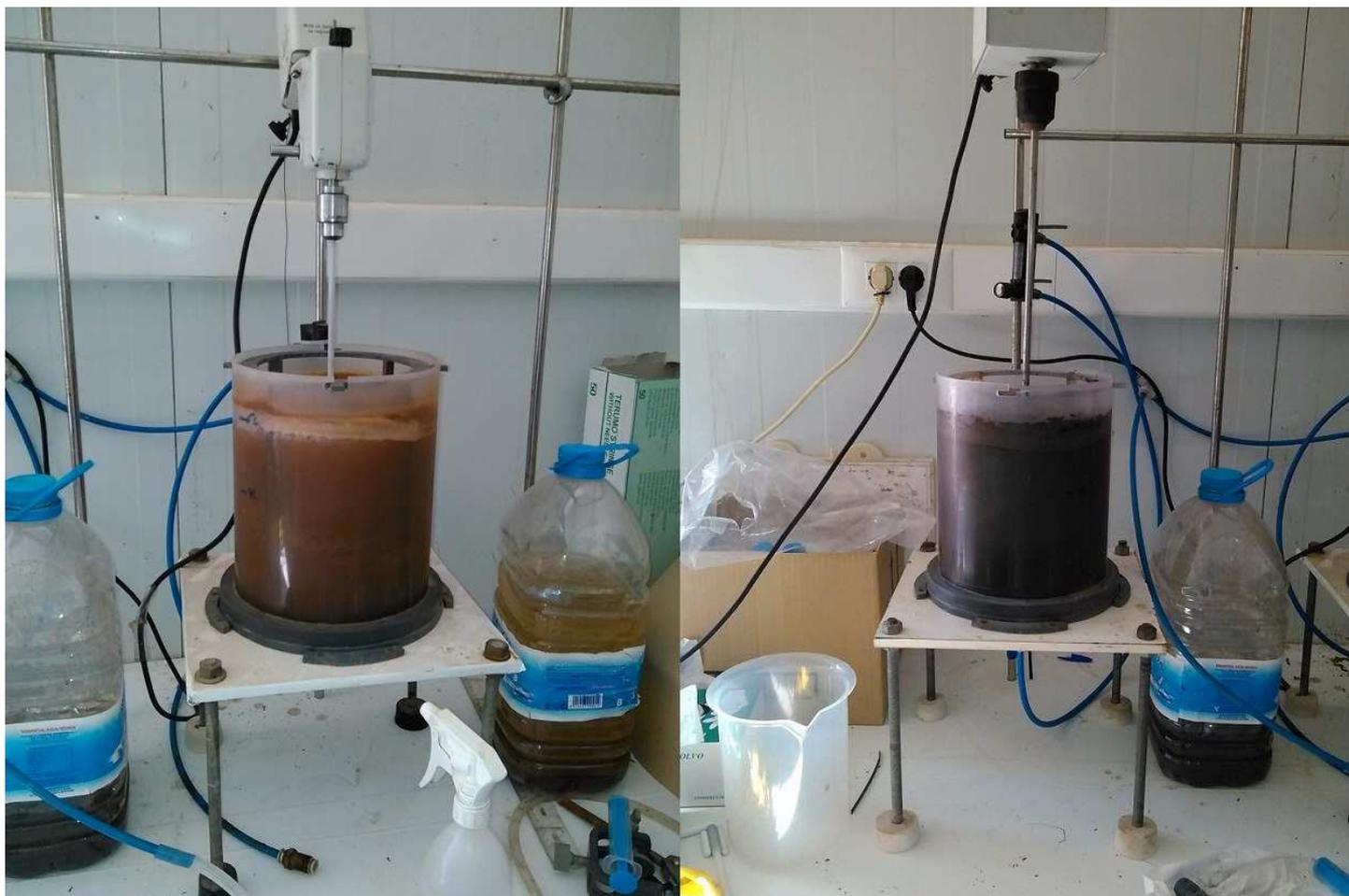
FIGURA 3: REACTORES SBR SIMULADOS EN LABORATORIO. Izq: fangos de Cítricos del Andarax. Der: fangos de El Toyo.
