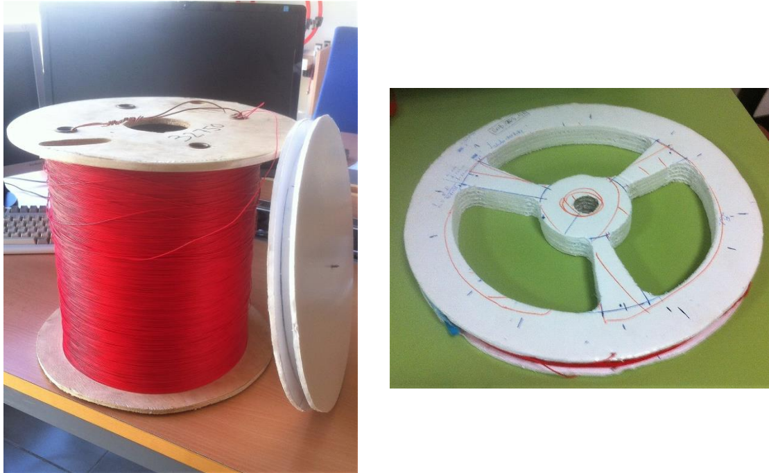
Figura 3-10: Carrete de hilo de cobre unifilar (izqda.), y bobina construida y terminada (dcha.).
