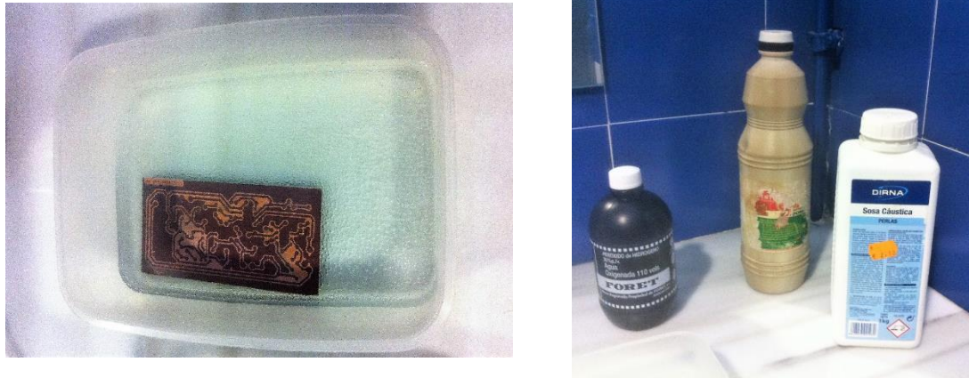
Figura 3-16: Atacado de placa (izqda.) y compuestos químicos utilizados en atacado y revelado (dcha.)
