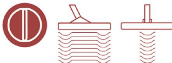
Figura 1-15: Forma del campo generado por la bobina en doble-D [1].
