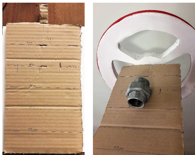
Figura 5-21: Regla de medida y soporte para muestras.
