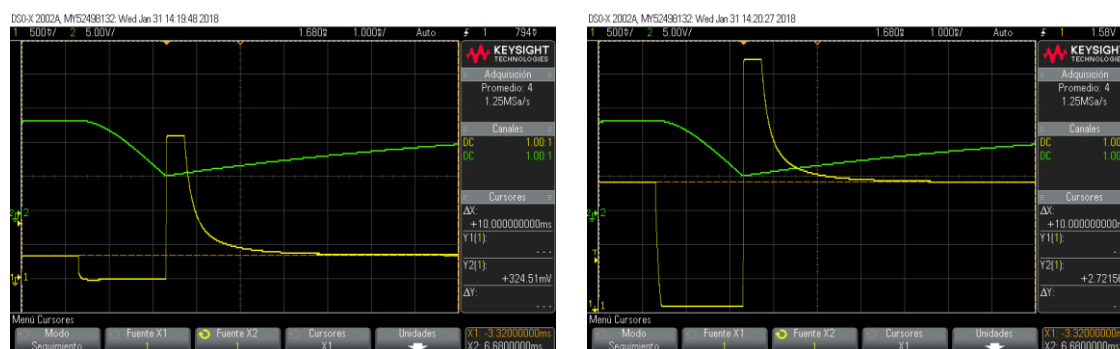
Figura 5-17: Modificación del offset en la etapa de acondicionamiento. Límites inferior y superior.
