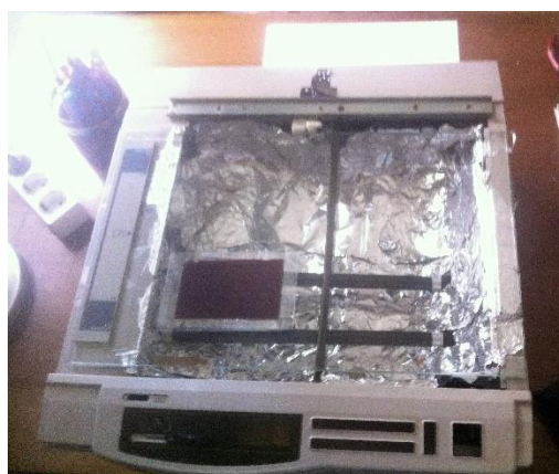
Figura 3-15: Insoladora casera que aprovecha la caja de una impresora.
