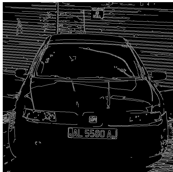
Figura 26. Contornos por algoritmo de Canny
