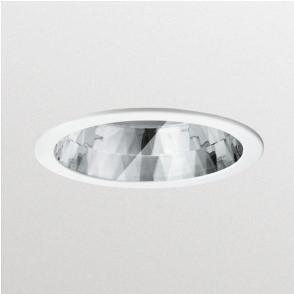
Europa 2 – downlight de altas prestaciones Europa 2 es un downlight fijo de montaje empotrado para lámparas fluorescentes compactas PL-C, con una óptica de alta eficiencia y clips de fijación regulables para simplificar la instalación. Estos downlights están disponibles en dos formatos y pueden equiparse con difusor prismático, difusor opal, cierre transparente, cristal decorativo, rejilla antideslumbramiento y cierre suspendido.
