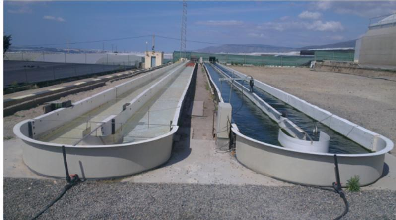
**Figura 1.1:** Fotobiorreactor raceway. Las Palmerillas.
