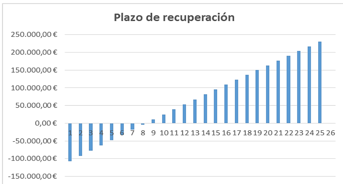
Figura 63. Instalación fotovoltaica: Plazo de recuperación
