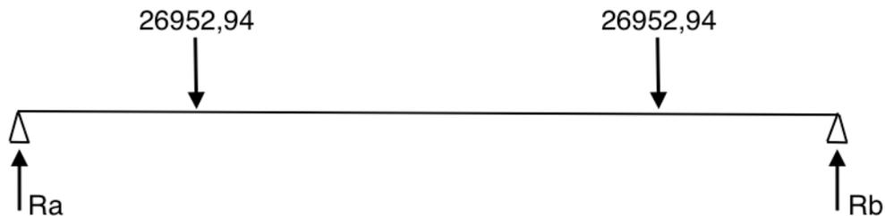
Figura 63. Distribución de cargas rodamientos
