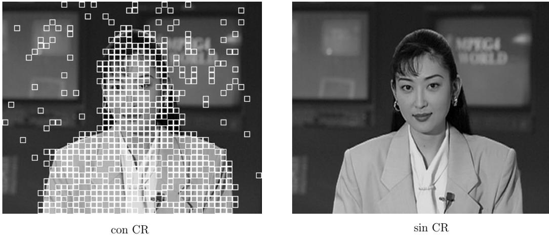
Figura 18. Reconstrucción visual de una imagen de la secuencia *Akiyo*, simulando una transmisión controlada por el cliente haciendo uso de CR y una transmisión estándar, utilizando un *bit-rate* de  $11 \times 10^6$  *bits* por segundo.
