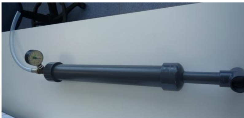
Figura: 51. Detalle bomba manual.
