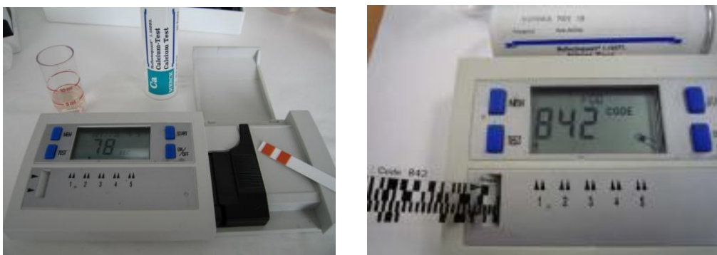
Figura 57. Detalle del proceso de medición mediante Reflectómetro.
