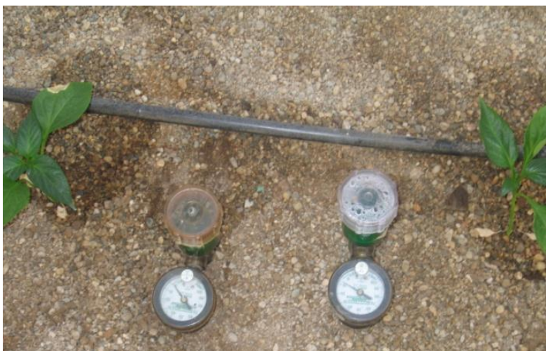
Figura 42. Detalle de tensiómetros.
