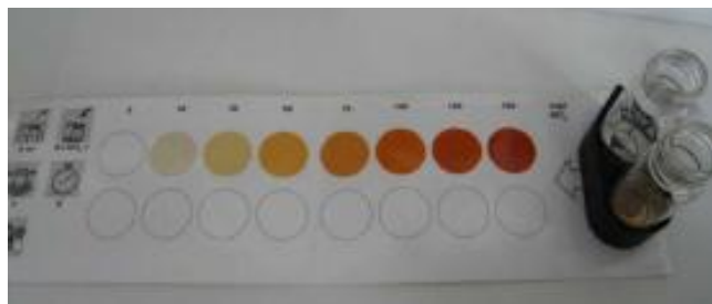
Figura 60. Colocar las muestras sobre el comparador desplazable.
