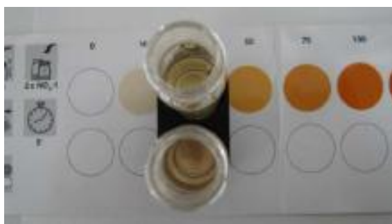
Figura 61. Determinación visual de la muestra sobre el comparador.
