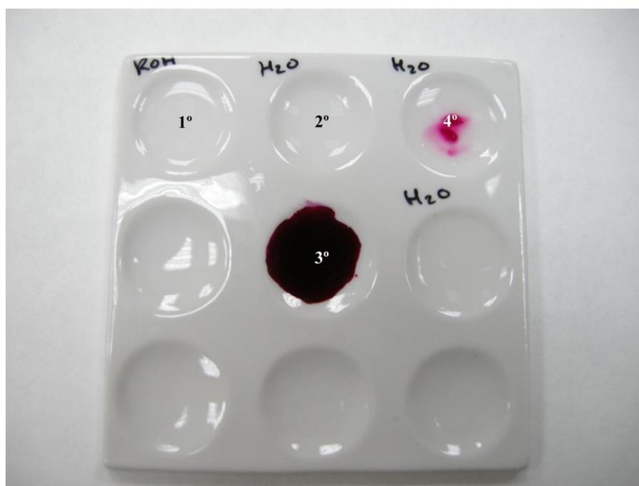
Figura 4. Itinerario de limpieza y tinción: 1° limpieza de impurezas en KOH 10%; 2° eliminación de KOH en agua destilada; 3° tinción de muestra con fucsina ácida; 4° eliminación de exceso de tinción en agua destilada (Fuente: Jesús Moreno Salmerón).
