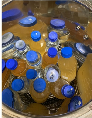
Imagen 11: Las botellas se introducen en el autoclave
