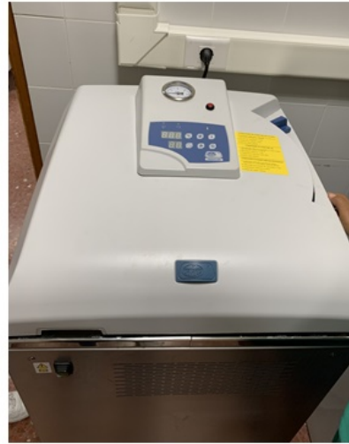
Imagen 12: Una vez en el autoclave, se ajusta la temperatura a 120°
