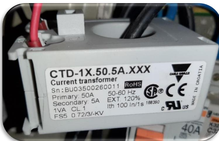
Figura 4.2. Toroidal empleado en las pruebas.
