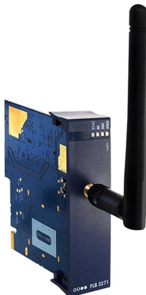
Figura 2.14. Tarjeta de expansión cliente wifi/WLAN de eWon.
