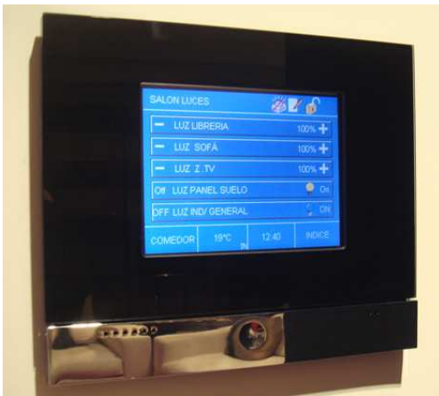
Figura 3. Los dispositivos que centralizan los sistemas domóticos permiten controlar la temperatura de cada habitación, las luces y los electrodomésticos desde una única interfaz, ahorrando tiempo y haciendo más cómodo su uso.
