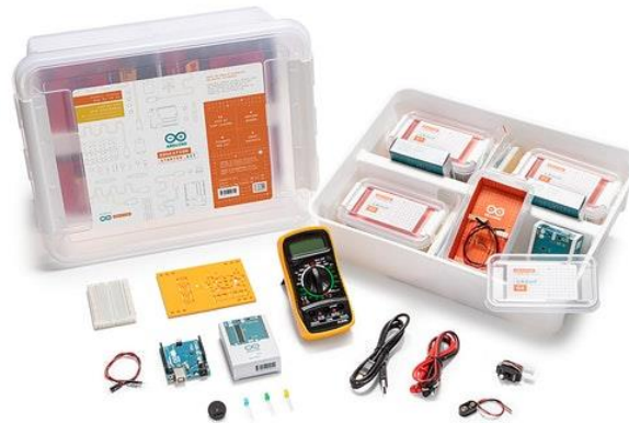
Figura 10. Kit educativo de Arduino con distintos sensores (Arduino, 2020a)
