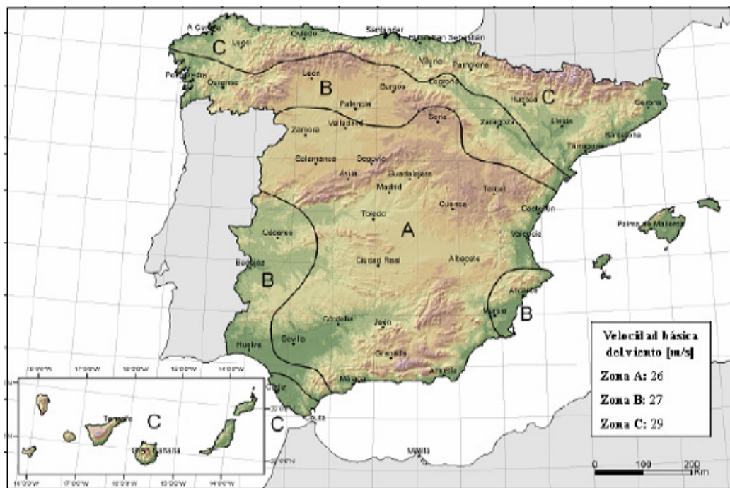
Imagen 1. Valor básico de la velocidad del viento ( v_b ).
