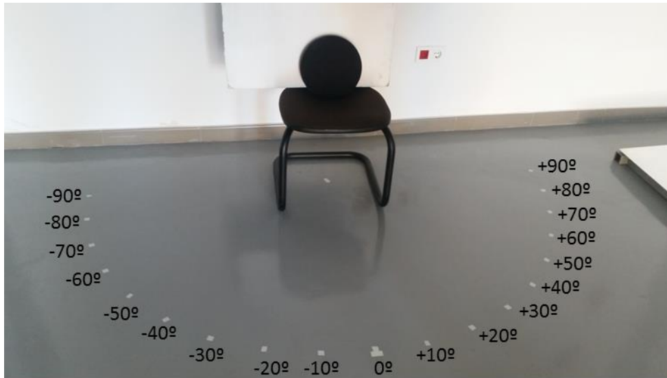
Figura 5.4.5. Test para estudio de comportamiento lambertiano en función del ángulo de medida
