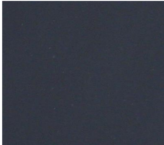
Figura 5.4.2. Área de 4x 4 cm del receptor pintado con Pyromark 2500
