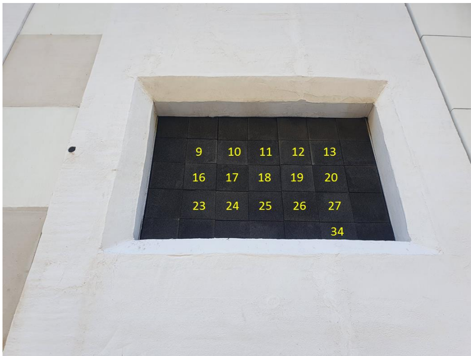
Figura 6.5.1.1. Copas centrales seleccionadas del receptor
