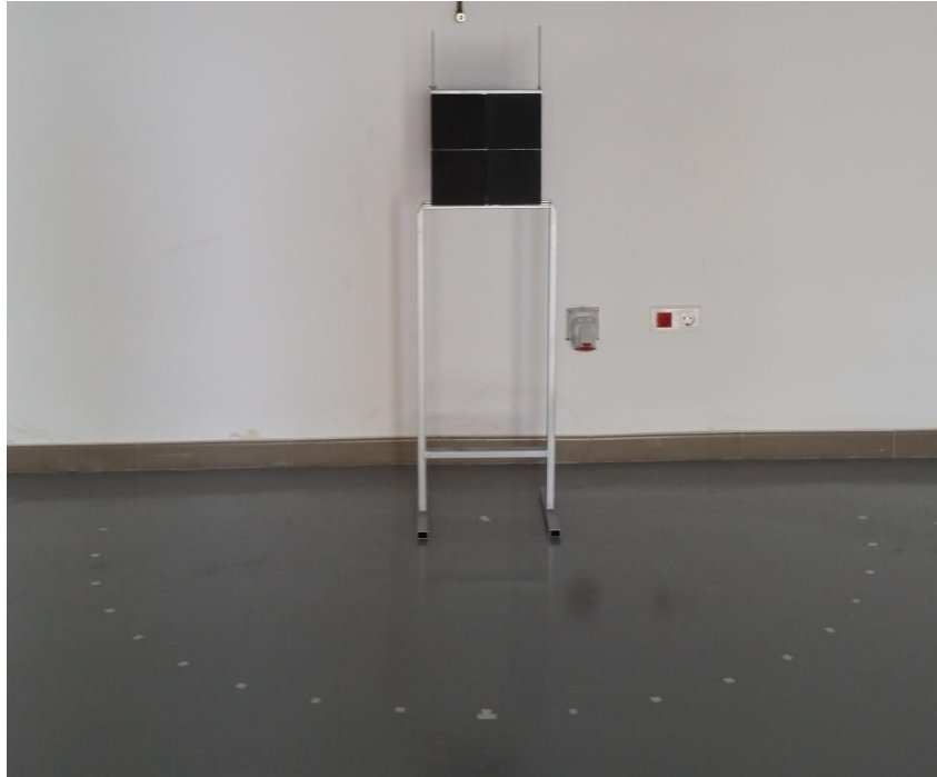
Figura 6.3.2. Test para estudio de la luminancia de la superficie del receptor en función del ángulo de medida
