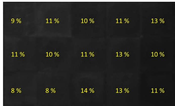
Figura 6.5.2.1.2. Incertidumbre en la irradiancia al medir sobre cada copa. Nivel 450 \text{ kW m}^{-2}
