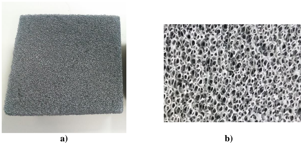
Figura 6.2.1. a) Módulo 140 \times 140 \text{ mm} de carburo de silicio. b) Zoom en el módulo poroso del receptor
