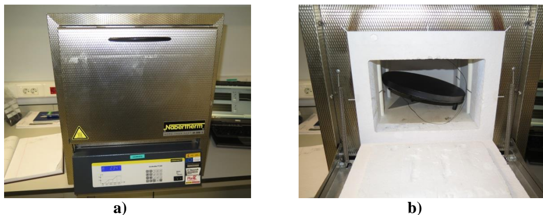
Figura 5.3.2. a) Horno mufla. b) Horno mufla abierto con el receptor dentro
