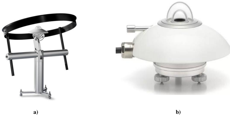
Figura 2.6.1. a) Piranómetro con disco para medir radiación difusa. b) Piranómetro sin disco para medir radiación global
