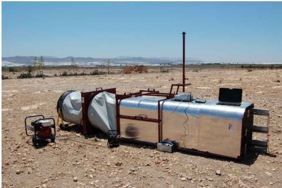
Figura 13. Estructura telescópica de nuestro túnel de viento e imagen del mismo desplegado
