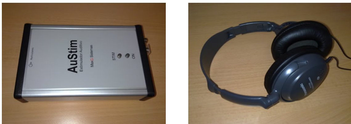
Figura 1.4: Recursos hardware para Potenciales Evocados Auditivos. (I) Módulo AuStim. (II) Auriculares.
