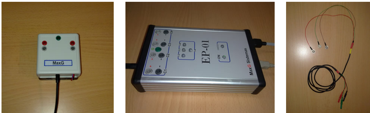
Figura 1.3: Recursos hardware para Potenciales Evocados Visuales. (I) Módulo ViStim. (II) Módulo EP-01. (III) Electrodo.
