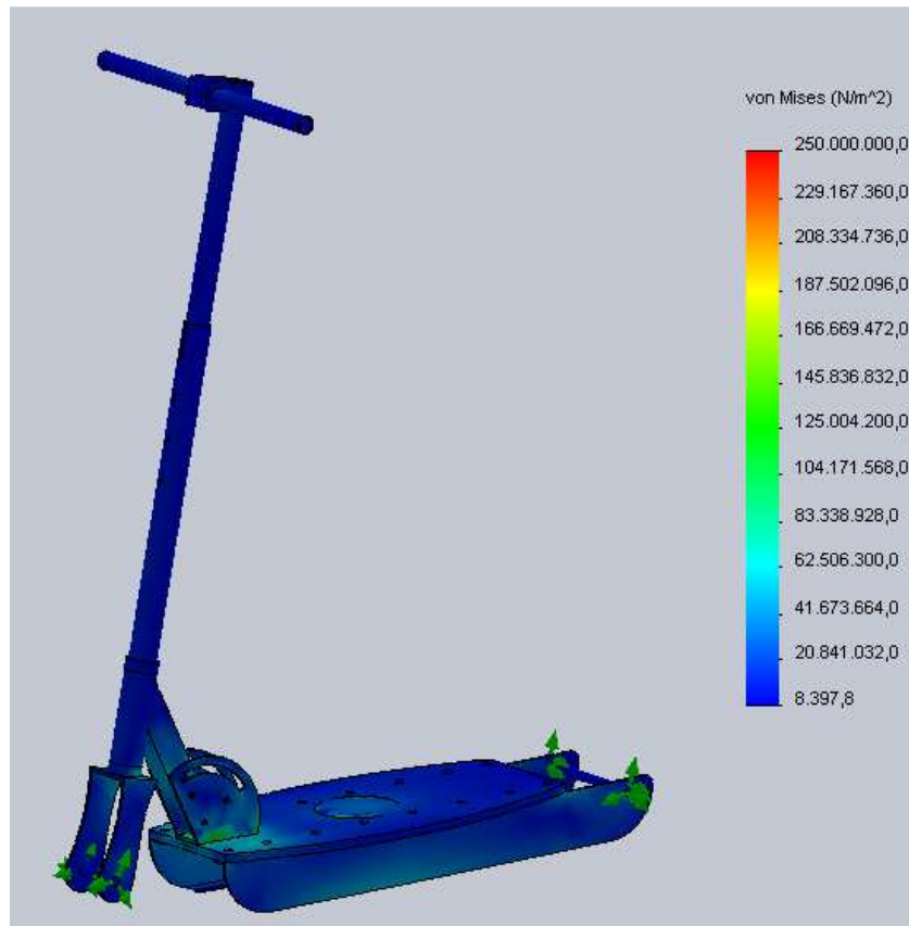
Ilustración 36: "tensiones de Von Mises en ensayo de caída"
