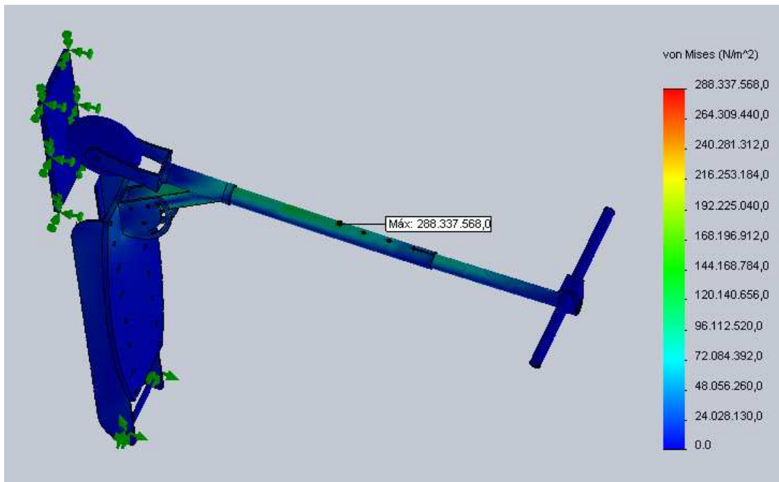
Ilustración 23: "distribución de tensiones de Von Mises en ensayo de carga estática en la dirección B"
