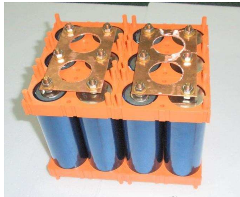
Ilustración 4: "batería LiFePo 4 formada por la unión de celdas en serie-parallel"
