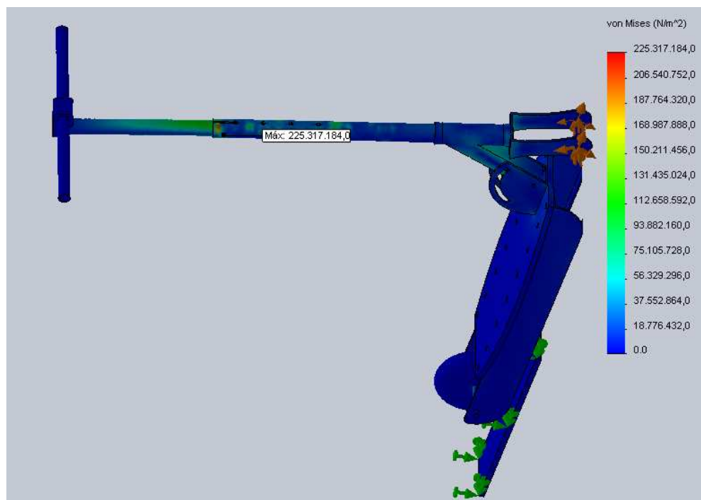
Ilustración 18: "resultados obtenidos para las tensiones de Von Mises tras modificar el material del cabezal"
