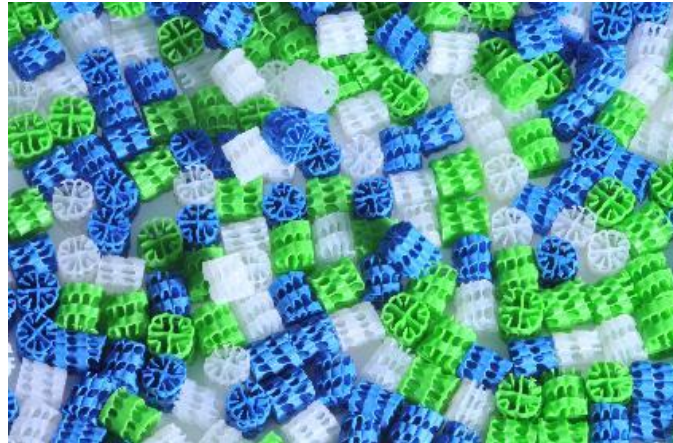
Imagen 2. Soportes plásticos para microorganismos en la tecnología MBBR (Chamorro, 2019).
