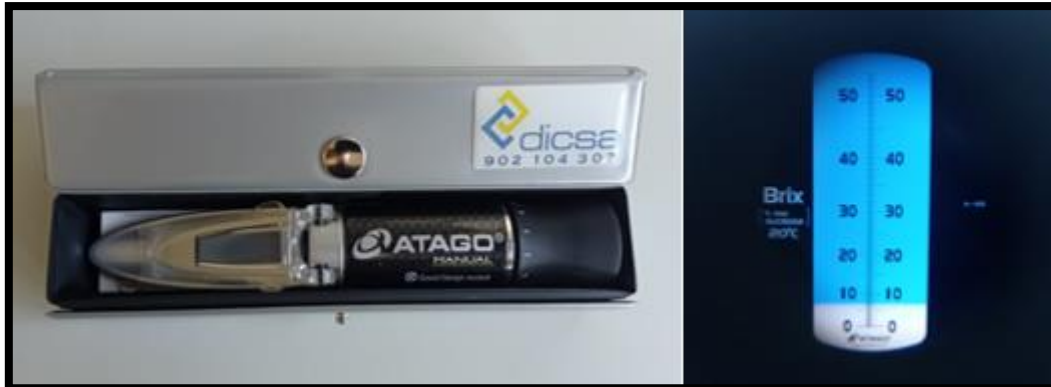
Figura 15. Refractómetro y detalle de lectura de °Brix (Elaboración propia).
