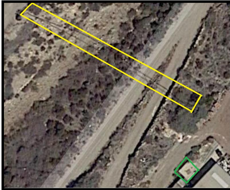
Figura 8. Cabezal de riego (verde) y tuberías (amarillo) (Elaboración propia).
