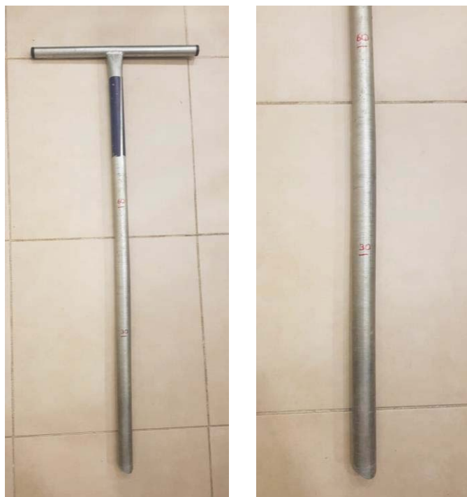
Figura 51. Barrena IW-60 empleada en la obtención de las muestras de tierra (Fuente: fotografía propia).
