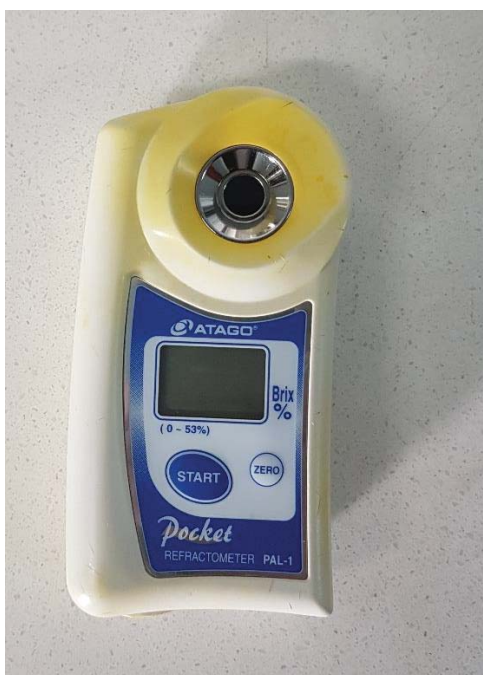
Figura 46. Refractómetro digital utilizado en la medición de los SST mediante medidas destructivas (Fuente: fotografía propia).
