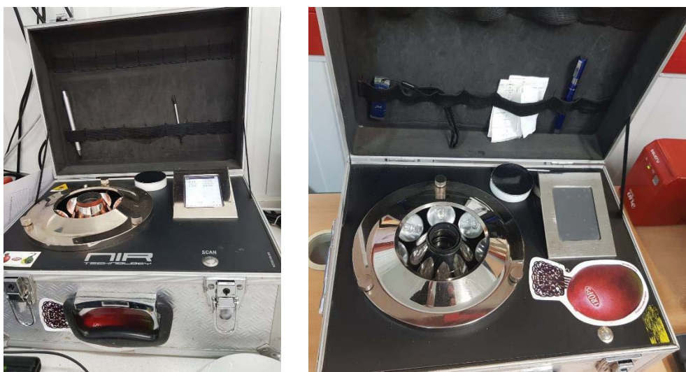
Figura 45. NIR no destructivo empleado en las mediciones de los parámetros de calidad de los frutos
