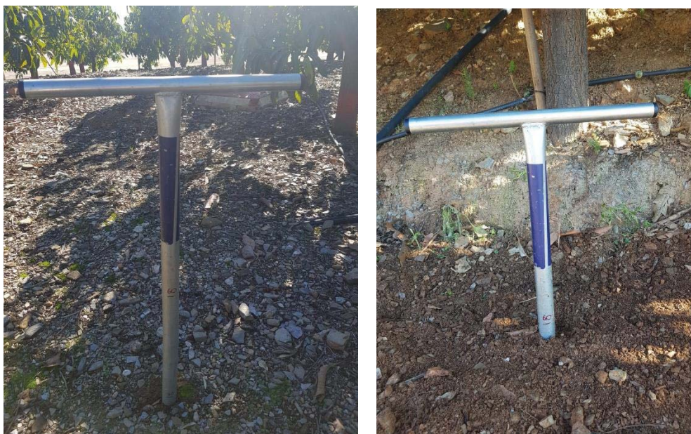
Figura 52. Barrena introducida en el suelo para coger la muestra de suelo de los primeros 30 cm de profundidad (izquierda) y entre los 30 y 60 cm de profundidad (Fuente: fotografías propias).
