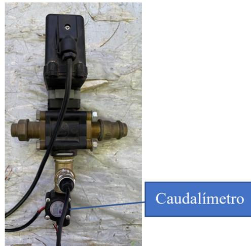
Figura 22. Detalle de la ubicación del caudalímetro. Fuente: Elaboración propia.
