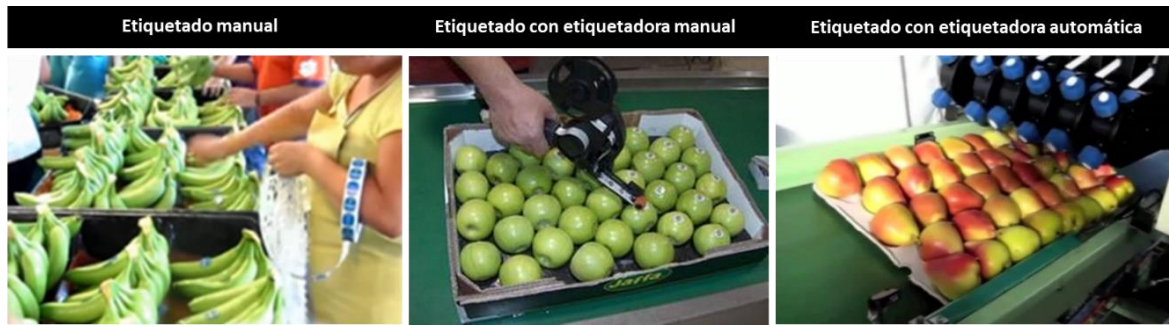
Figura 9. Formas de colocar la etiqueta sobre fruta desnuda.
