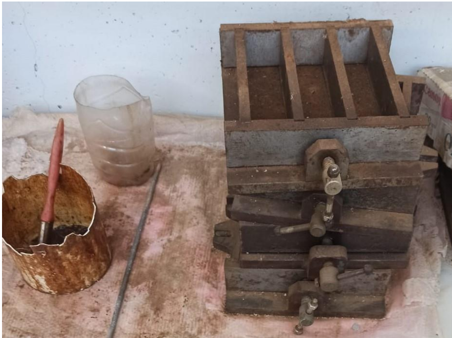
Figura 3.16. Moldes para probetas de 40 mm x 40 mm x 160 mm empleados para hacer las probetas de escayola reciclada.
