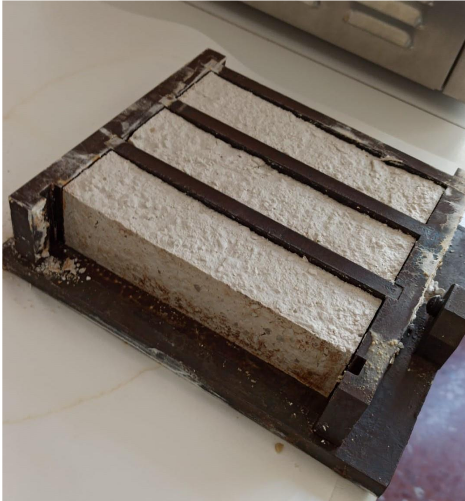
Figura 3.18. Desmoldado de las probetas de escayola reciclada.
