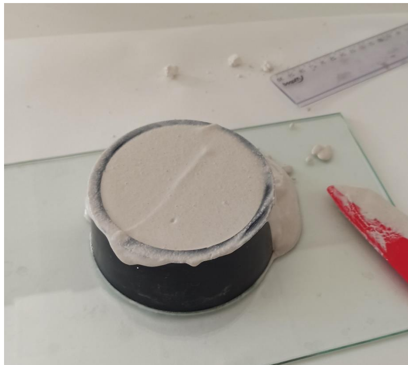
Figura 3.14. Cono truncado relleno en el ensayo de fluidez de la pasta de yeso.
