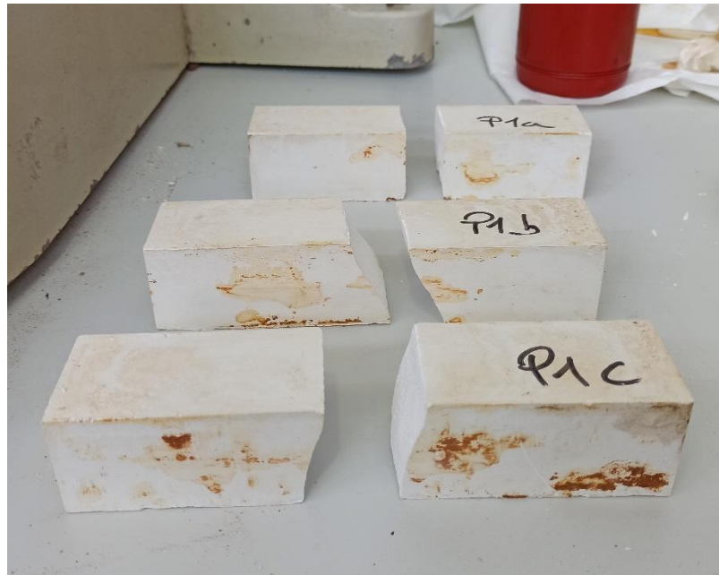
Figura 3.23. Probetas fracturadas tras el ensayo de flexión.
