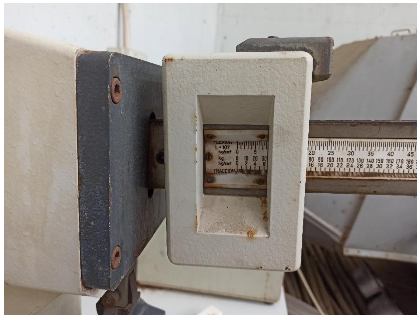
Figura 3.22. Escalas de medida de la prensa IBERTEST GL500. El marcador de la carga aplicada se encuentra en el centro de la ventana rectangular, solidario a la pesa en forma de prisma que se desplaza a lo largo del brazo con la escala.
