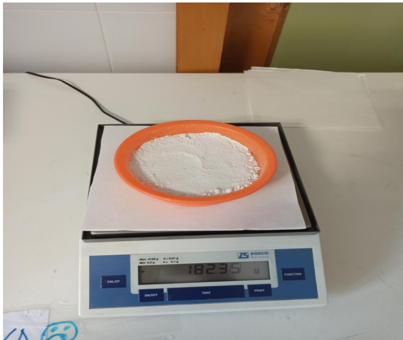
Figura 3.9. Balanza BOECO de sensibilidad 0,01 g del laboratorio de materiales, utilizada para realizar los ensayos de granulometría.
