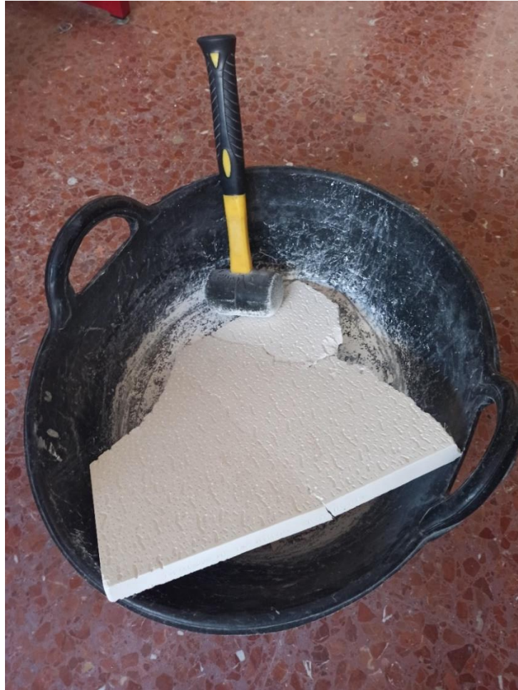
Figura 3.4. Primera fase del proceso de molienda.
