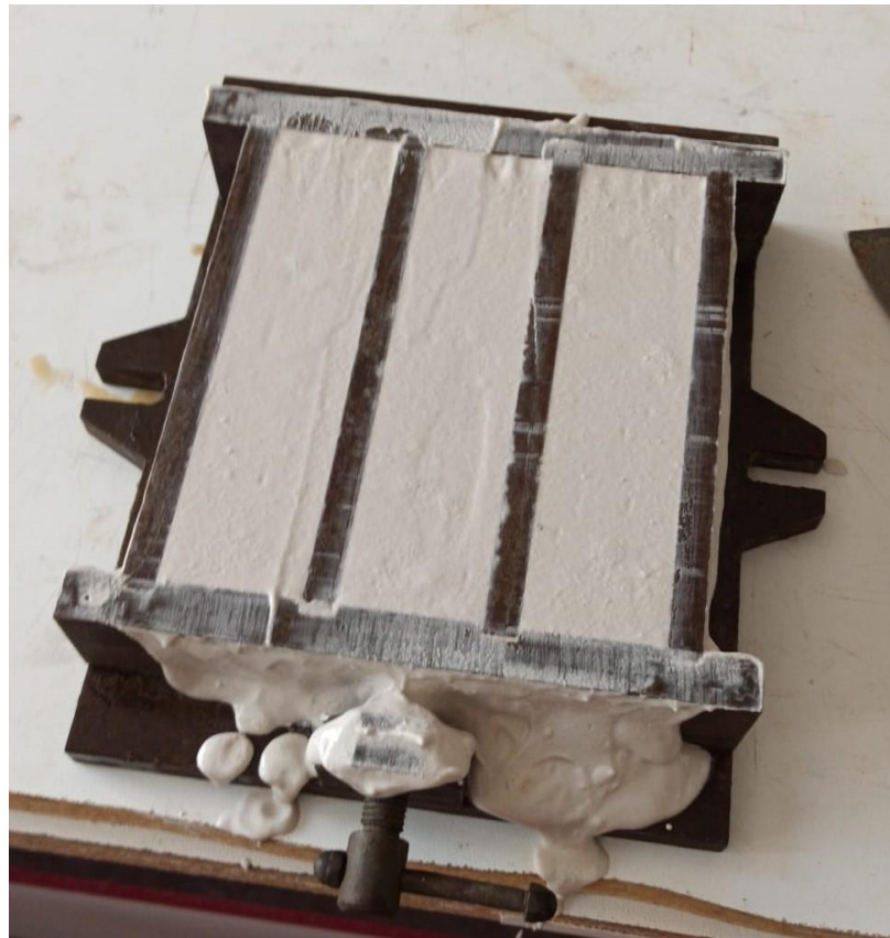
Figura 3.17. Molde relleno de escayola reciclada para fabricar una serie de probetas para los ensayos mecánicos.
