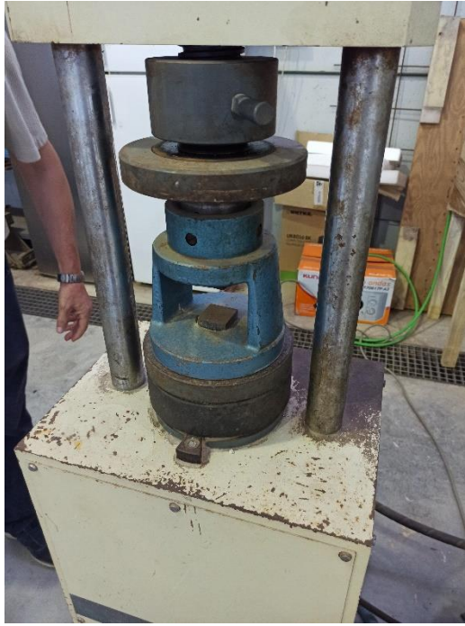
Figura 3.27. Detalle del adaptador de los platos de la prensa a una superficie cuadrada de 40 mm x 40 mm para ensayar probetas de esta sección.
