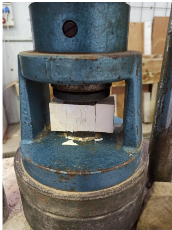
Figura 3.29. Momento de la rotura de una probeta en el ensayo de compresión.
