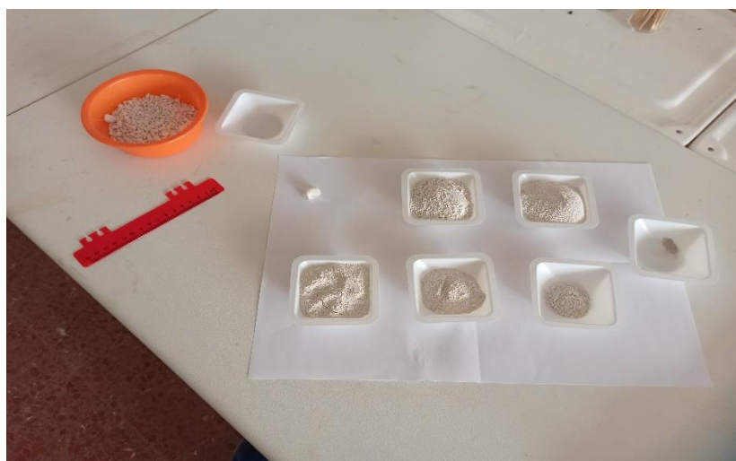
Figura 3.11. Muestras retenidas en cada uno de los tamices recuperadas en bandejitas de plástico para pesar durante la realización de la granulometría.
