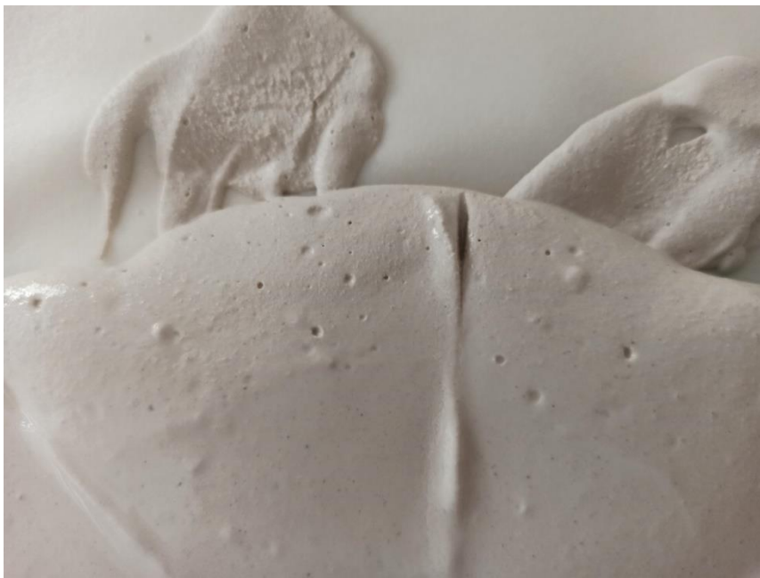
Figura 3.15. Hendidura formada en la galleta al realizar cortes con un cuchillo para determinar el principio de fraguado.
