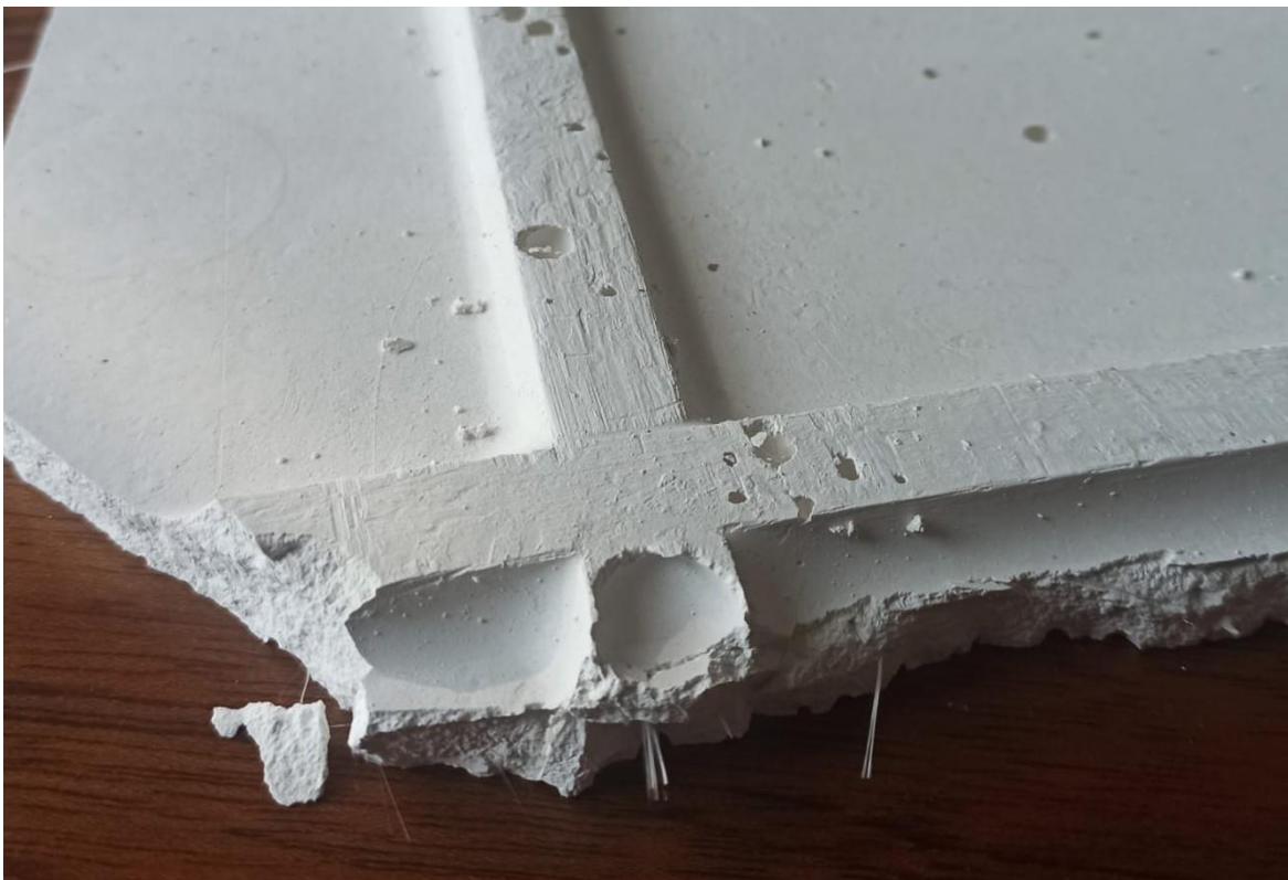
Figura 3.3. Presencia y distribución de la fibra de vidrio en las placas.
