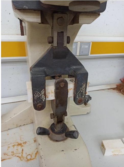
Figura 3.21. Probeta de escayola montada en el soporte y preparada para comenzar el ensayo de flexión.
