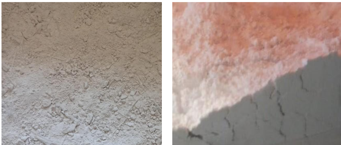
Figura 4.1. Aspecto de la molienda gruesa (izquierda) y molienda fina (derecha). Los dos residuos recuperados son muy blancos, el color anaranjado de la molienda fina es un efecto de la iluminación.
