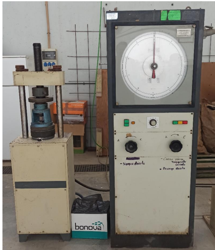
Figura 3.24. Prensa de compresión IBERTEST de 15 toneladas ubicada en la nave de Ingeniería de la UAL.
