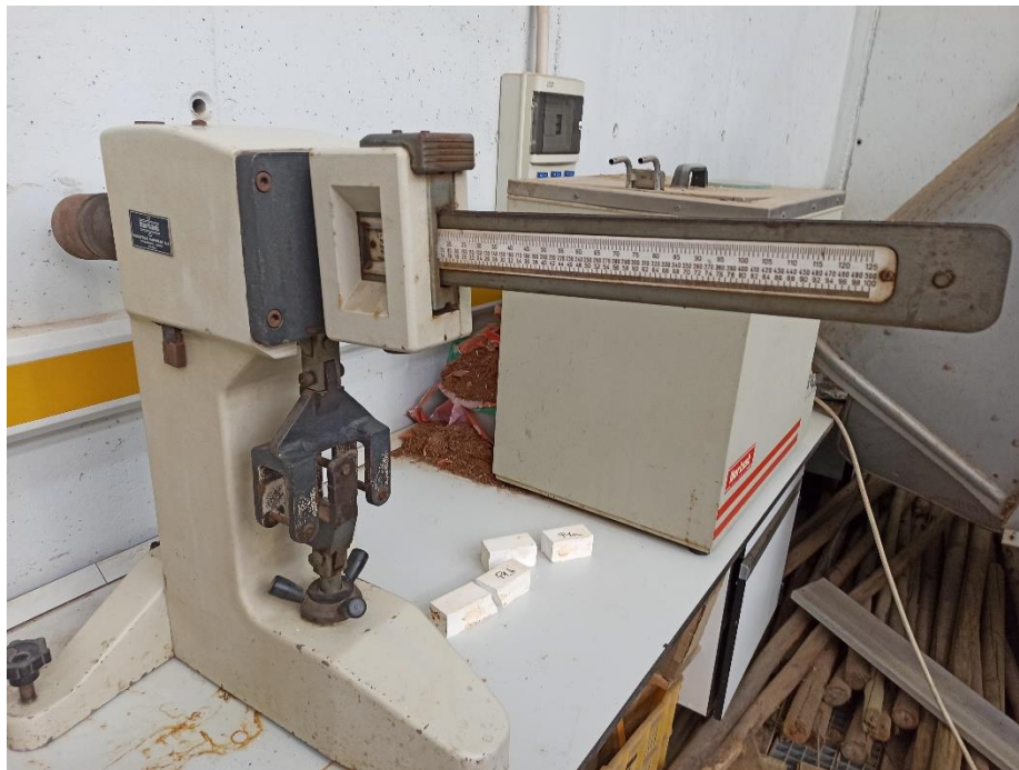
Figura 3.20. Prensa de flexión IBERTEST GL500 ubicada en la nave de Ingeniería de la UAL.
