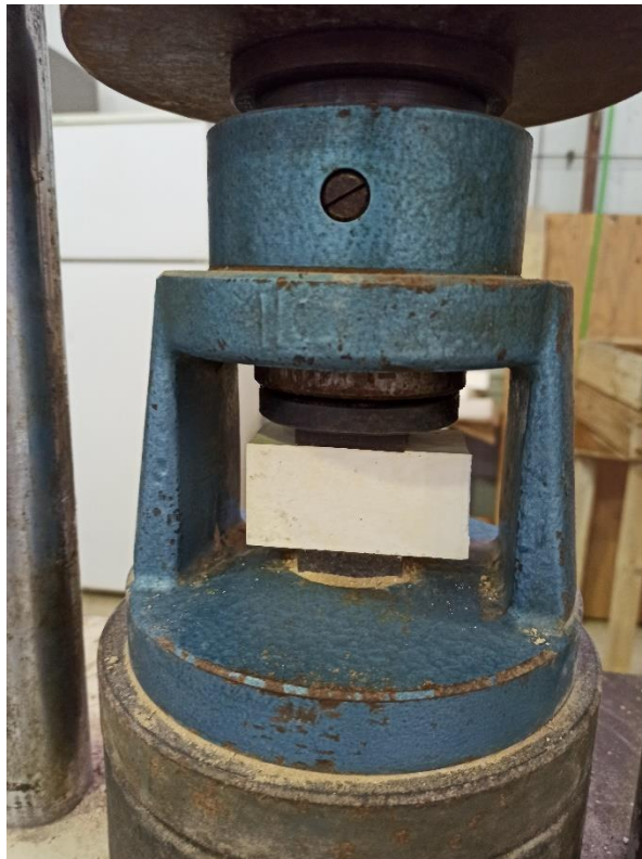
Figura 3.28. Detalle de la probeta colocada para la realización del ensayo de compresión.
