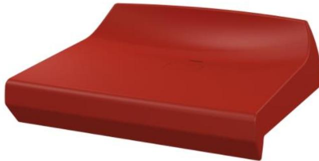
Carcasa monobloque moldeada por inyección en plástico estabilizado de alta calidad (polipropileno copolímero). Superficie en brillo y cerrado en todo su perímetro de apoyo sobre grada para facilitar la limpieza. Frontal moldeado en escuadra de 35 mm, que bordea sobre el frente de grada. Fijación en un solo punto central de anclaje reforzado con planchuela de acero. Desagüe central. Perfil ergonómico con apoyo lumbar.
