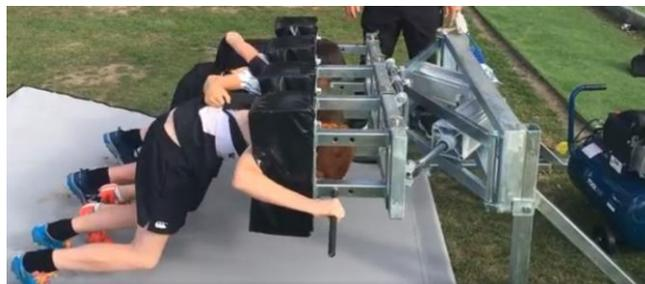
Figura 4. Modelo neumático de Live Scrum. [6]
