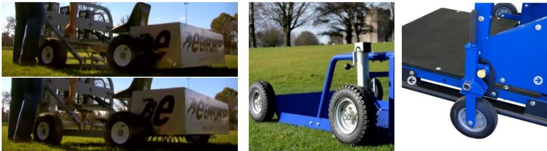
Figura 13. Sistema hidráulico (1), elevación mediante husillo (2) y accionado por palanca (3). [8] [13][18]
